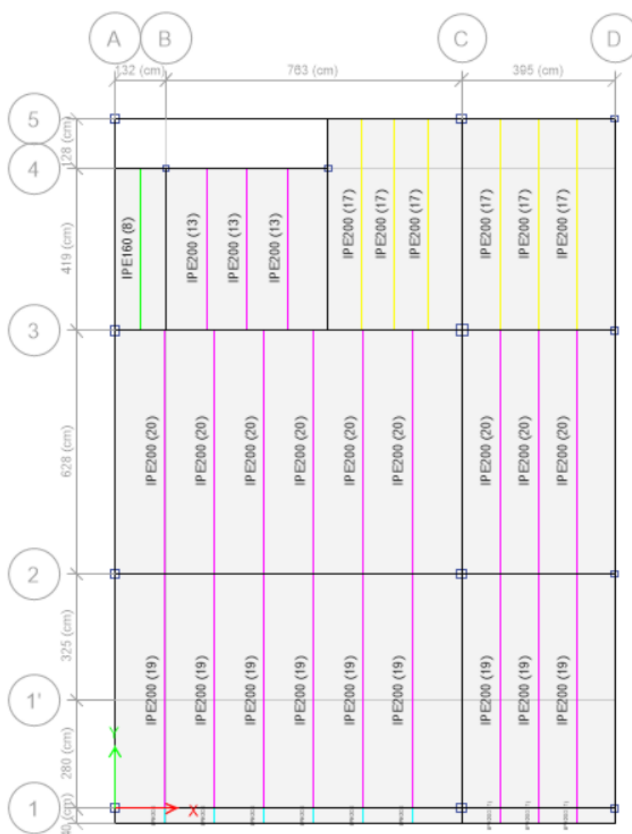
طراحی تیرهای کامپوزیت سقف در طبقه Roof
